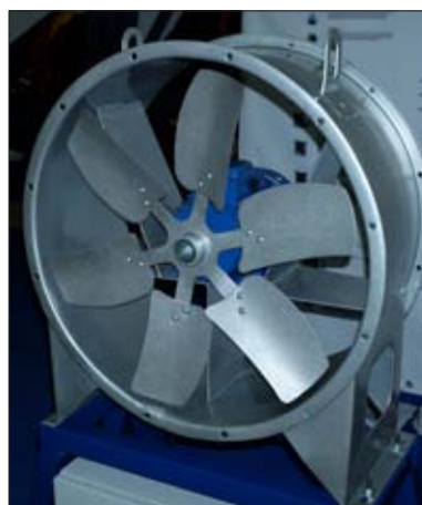
■ Рис. 2. Осевые вентиляторы с упрощенными некрутящимися лопатками и большими радиальными зазорами между лопатками и корпусами
