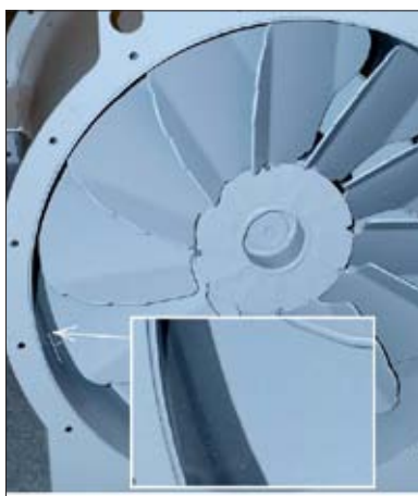
■ Рис. 2. Осевые вентиляторы с упрощенными некрутящимися лопатками и большими радиальными зазорами между лопатками и корпусами
