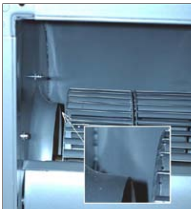
■ Рис. 3. Огромные зазоры между входными коллекторами и колесами
